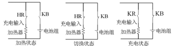
图 3 电池充电切换过程
