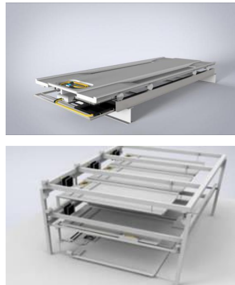
图1 立体停车库无线充/供电
