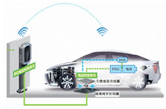
图1 电动汽车无线充电系统的原理示意
